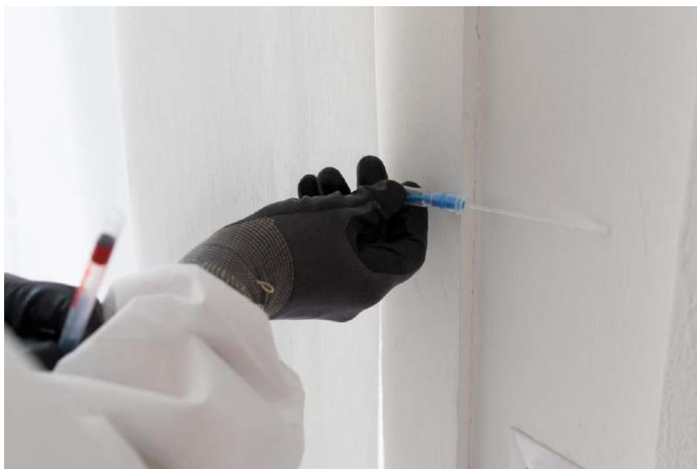
Figura 7 – Prelievo con tampone della carica microbica
