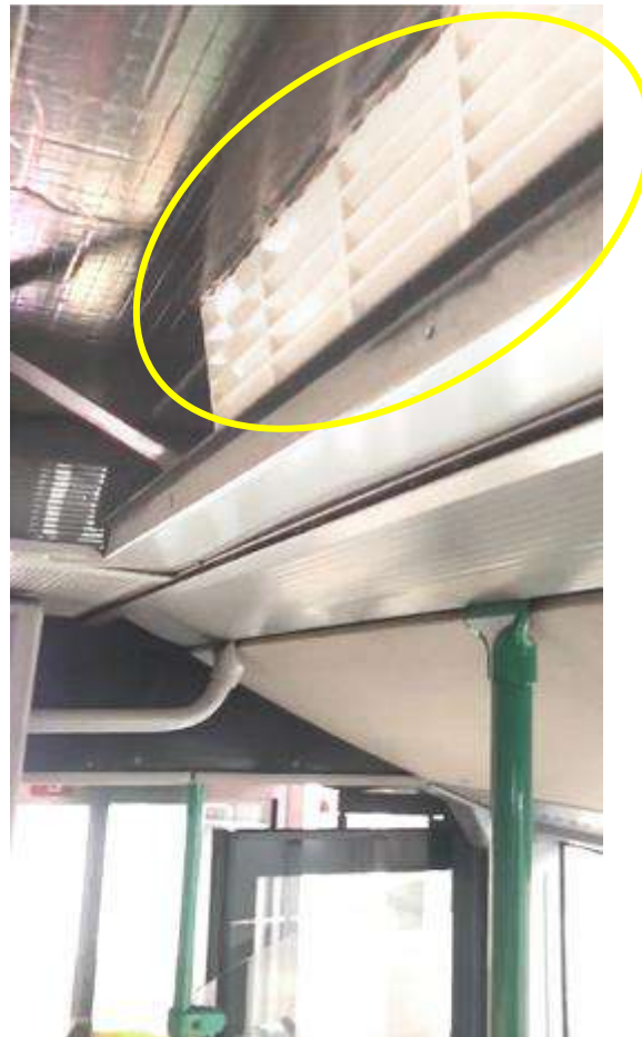
Figura 4 - Sistema di purificazione dell'aria integrato in un autobus
