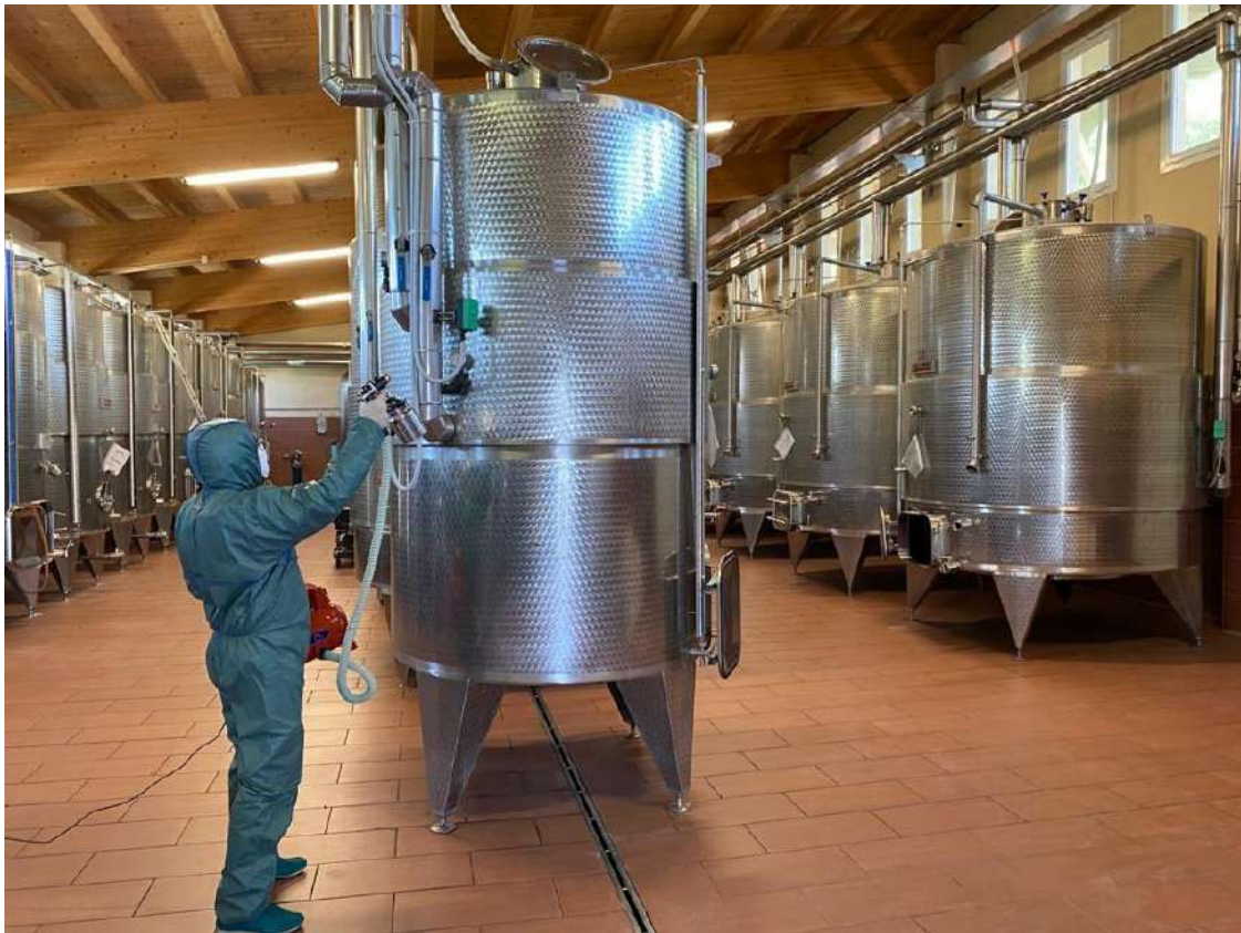
Figura 5 – Applicazione di coating fotocatalitico in ambito industriale
