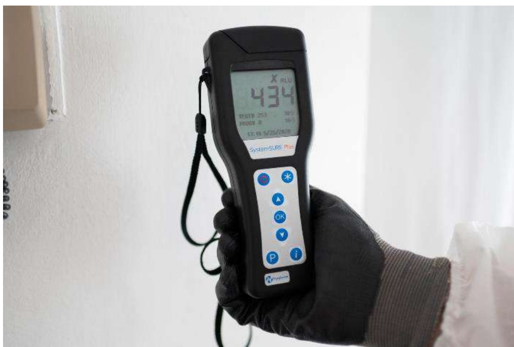
Figura 8 – Misurazione della carica microbica -prima del trattamento
