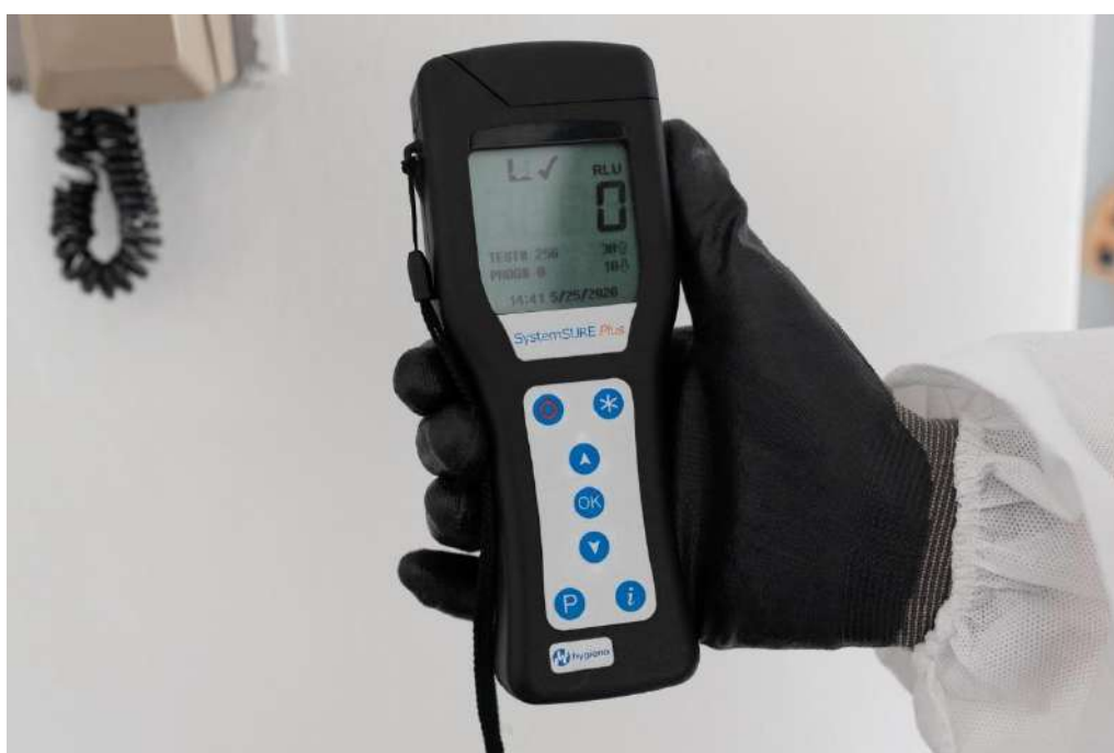
Figura 9 – Misurazione della carica microbica -dopo il trattamento
